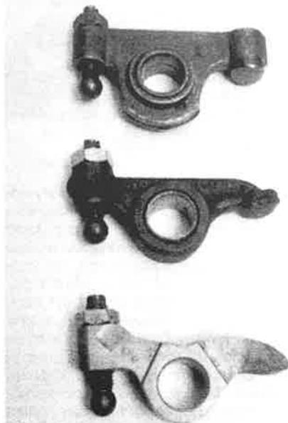
Lisované vahadlo (hora) a kované vahadlo z typu Cooper S (stred) sú pre výkon najlepšie, ale dnes sú bohužiaľ vzácné. Štandardné vahadlo vyrobené spekáním technológiou práškovej metalurgie (dole) vám urobí tú istú službu
